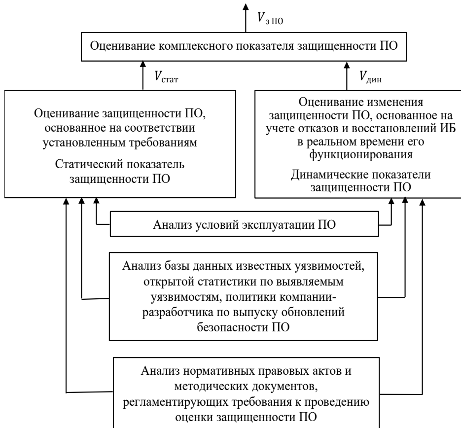
Рис. 3. Структурная схема процедуры агрегирования показателей защищенности ПО в процессе эксплуатации в АС ОВД в комплексный показатель и их оценивания
